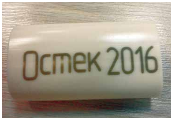
9 Лазерная гравировка ПВХ-трубки
