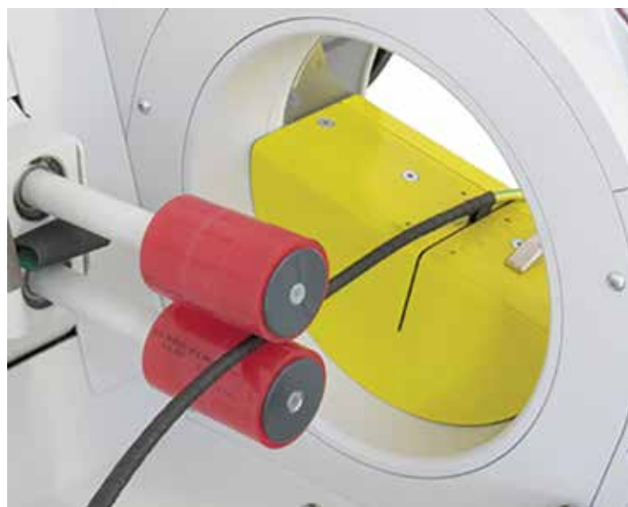
3 Обмотка ствола жгута лентой типа ПВХ
