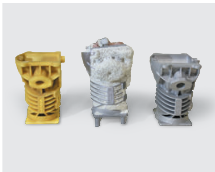
Демонстрация процесса литья по ПММА-моделям: выжигаемая модель, отливка с остатками керамической формы и готовая отливка
