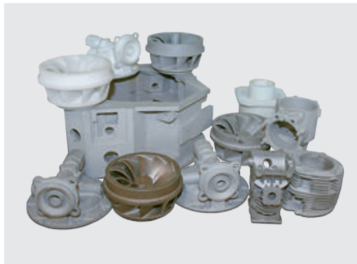
1 Напечатанные выжигаемые модели из ПММА и отливки из металла, сделанные с их помощью методом ЛВМ
