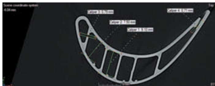
Срез лопатки турбины, полученный с помощью системы компьютерной томографии v|tome|x c450 General Electric
