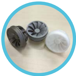
Напечатанная из ПММА модель «Крыльчатка» и отливки из алюминия и стали
