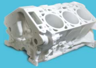
Напечатанная из ПММА выплавляемая модель «Блок цилиндров»
