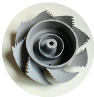
Отливка «Импеллер» из АК12, сделанная по модели из ПММА
