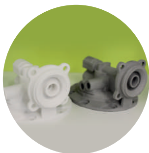
Напечатанная 3D-модель «Корпус» и отливка из АК7ч
