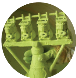
6. Нанесение последующих керамических слоёв
