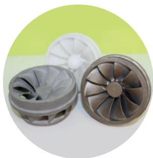
Напечатанная 3D-модель «Импеллер» и отливки из сплава АК7ч и стали 40Х13
