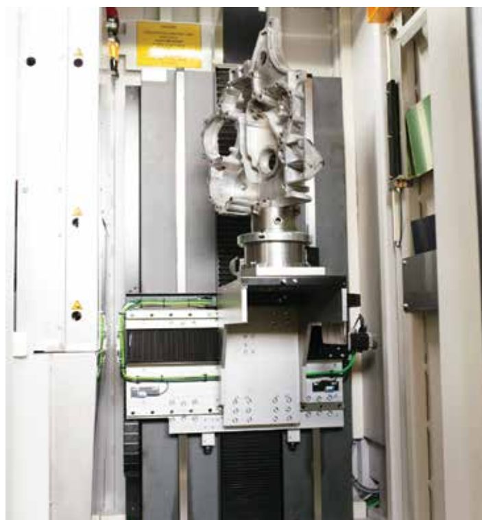
2 Крышка картера, установленная в томограф v|tome|x s450 для исследований внутренних пустот
