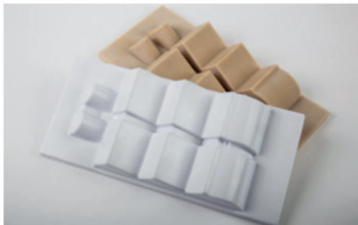
4 Изделия, произведенные вакуумной формовкой по оснастке из керамонаполненного пластика PLASTCure Rigid 10500. Оснастка напечатана по технологии MOVINGlight®
