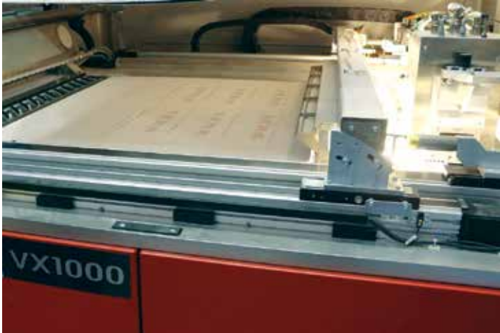
2 Процесс печати выплавляемых моделей на промышленном 3D-принтере Voxeljet VX1000
