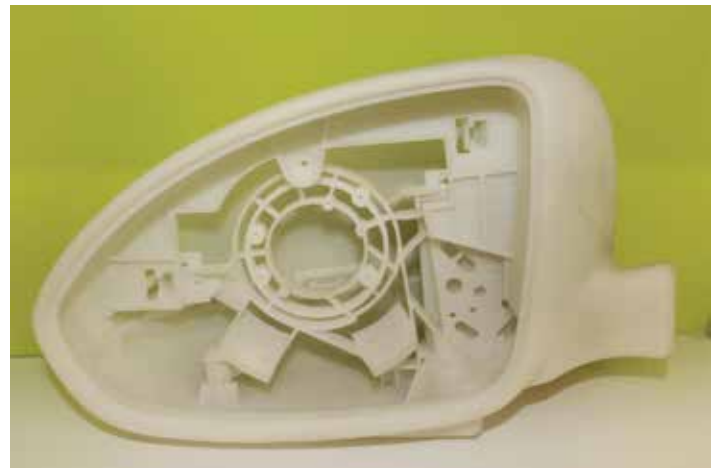
9 Напечатанное на промышленном 3D-принтере из полиамида автомобильное зеркало
