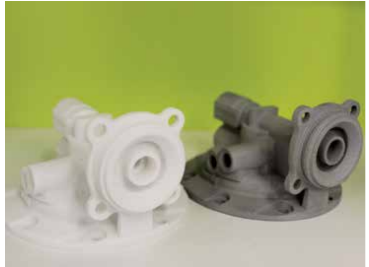
8 Напечатанная на 3D-принтере выплавляемая модель корпуса для водонапорной станции и отливка из алюминия по ней
