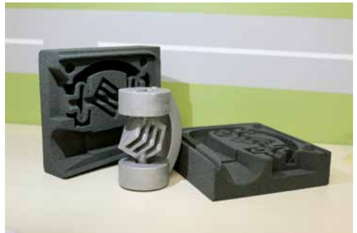
4 Напечатанная на 3D-принтере Voxeljet разъемная песчаная форма и отливка из алюминия
