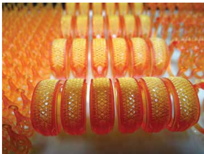
1 Серия колец для литья, напечатанная из выжигаемого фотополимера по технологии MOVINGLight® DLP
