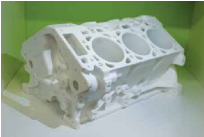
3 Напечатанная выплавляемая 3D-модель блока цилиндров для дальнейшего литья из металла
