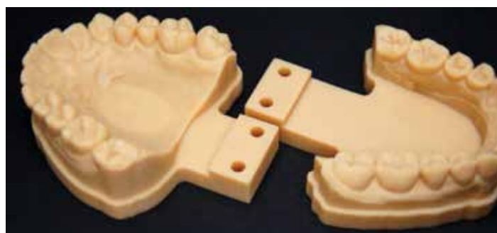
6 Напечатанные на промышленном 3D-принтере Prodways модели из фотополимера для задач стоматологии
