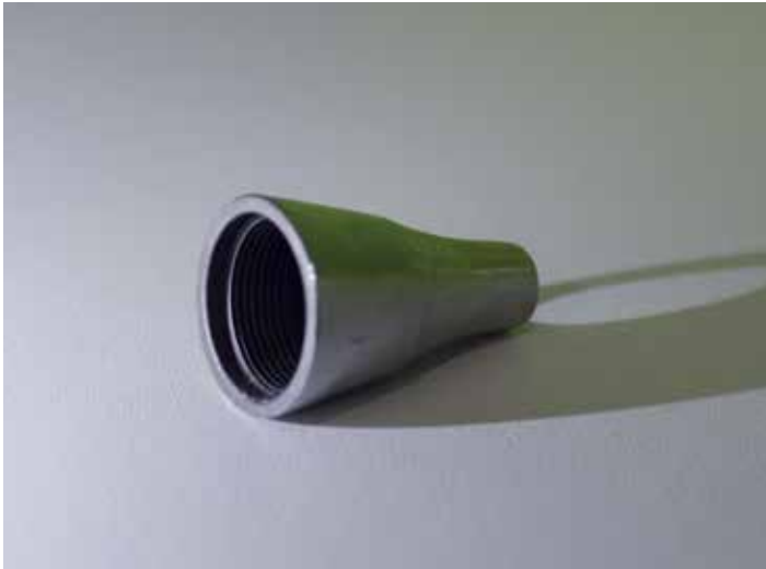
7 Напечатанное на промышленном 3D-принтере сопло из металла
